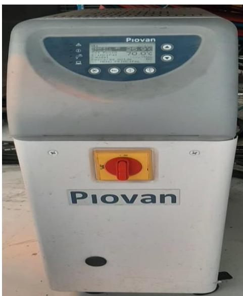
Al igual lleva un recirculamiento de agua en ciertas zonas del molde que es controlado por medio de un termo regulador a 70° C, esto nos ayuda a tener un control de temperatura óptimo en todas las partes del molde.
