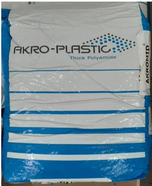
Esta es la materia prima que se usa para la fabricación de los tubos de plástico, se trata de una poliamida (plástico con fibra de vidrio), la poliamida que se utiliza viene en costales de 25 kg. de pequeños pellets (resina).
