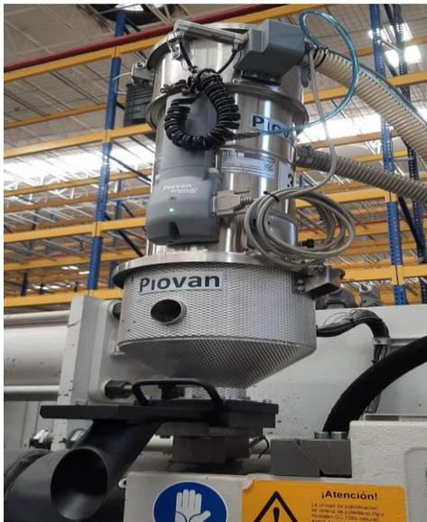
Ya que la resina paso por el proceso de secado y se le retiro la humedad, pasa a otra tolva más pequeña por medio de unas tuberías de absorción, esta tolva ya se encuentra en la unidad de inyección de la máquina, la capacidad de esta tolva es de 25 kg.
