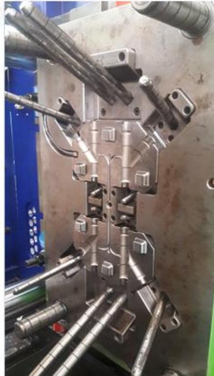
Antes de la primera impresión, se debe rociar el agente de desmoldeo en el molde y la impresión debe comenzar de esta manera. Los pasadores de cuerno, el núcleo y los cojinetes del núcleo del molde deben limpiarse periódicamente y engrasarse con aceite apropiado.
