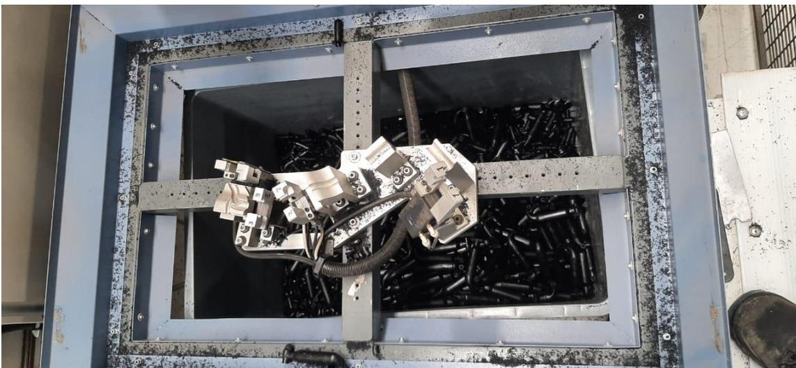
Posteriormente el brazo robótico cambia de herramienta, deja la ventosa y toma este disco de corte para cortar los extremos (rebaba) sobrante del tubo de plástico.
