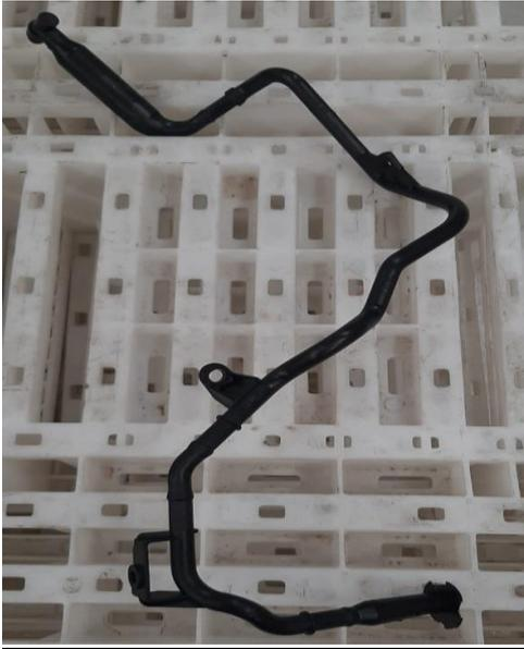
Por cuestiones de confidencialidad no se muestra el proceso completo de moldeo del tubo de plástico, ya cuando la máquina termina el ciclo de inyección así es como queda el tubo de plástico, en los extremos queda rebaba que posteriormente se muestra como se corta.
