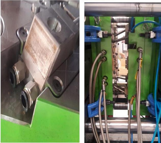
Hay manguera de aire y registro de aire en las conexiones de agua del molde.
