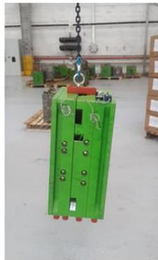
Para no abrir el molde durante el transporte del molde tiene un seguro. Hay un switch y una conexión de termopar para la temperatura del molde.
