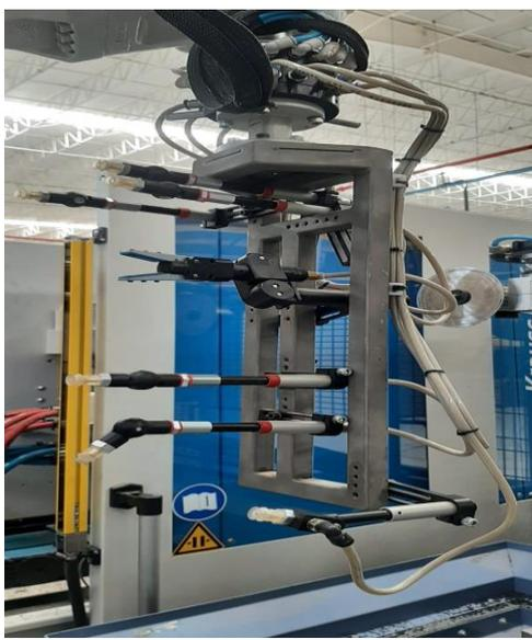
Después de terminar de cortar la rebaba sobrante del tubo vuelve a tomar la ventosa para tomar el tubo ya cortado y pasarlo a un contenedor de producto semi terminado.
