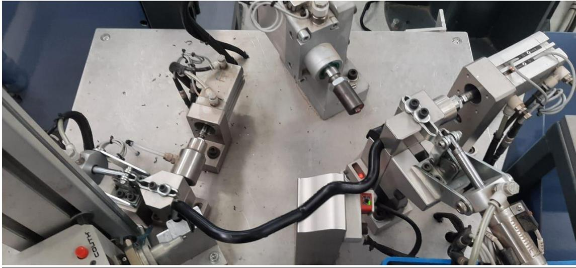
Si el tubo semi terminado pasa **OK** el proceso de prueba de fuga, pasa al siguiente proceso de marcado, donde el brazo robótico lleva el tubo hacia donde se encuentra una marcadora laser la cual tatúa la fecha (día/mes/año) y el número de empleado del operador en turno que estaba trabajando esa celda robótica.
