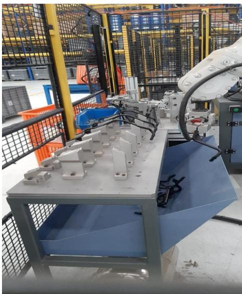
Si el tubo semiterminado esta **OK** en el proceso de control de diámetro, el brazo robótico deja el tubo en un determinado recipiente para el siguiente proceso de prueba de fuga.
