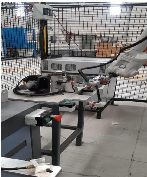
Después de haber terminado el proceso de fresado pasa al proceso de control de diámetro, donde entra una cuerda de un determinado diámetro por un extremo del tubo y tiene que salir por el otro extremo, si esta cuerda no sale inmediatamente el brazo robótico envía este tubo a **SCRAP**, pero si esta cuerda si sale el tubo esta **OK** y pasará al siguiente proceso de prueba de fuga.
