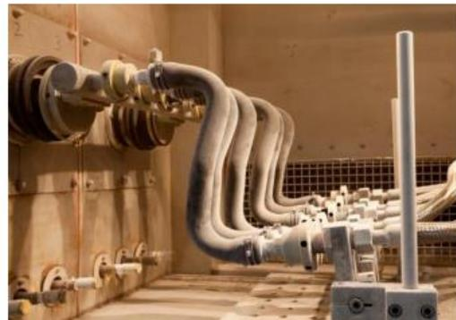
**Control y medición:** escantillón de control de tubería y medición 3D con CMM y escáner óptico.
