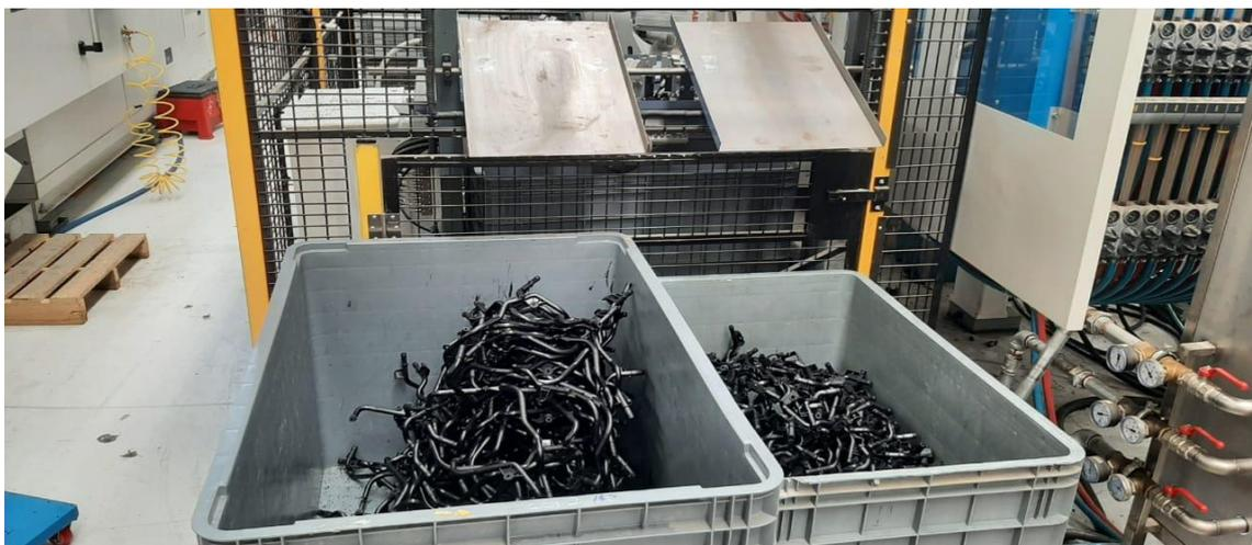
El tubo plástico semiterminado es colocado en estos fixture para su posterior proceso de fresado.
