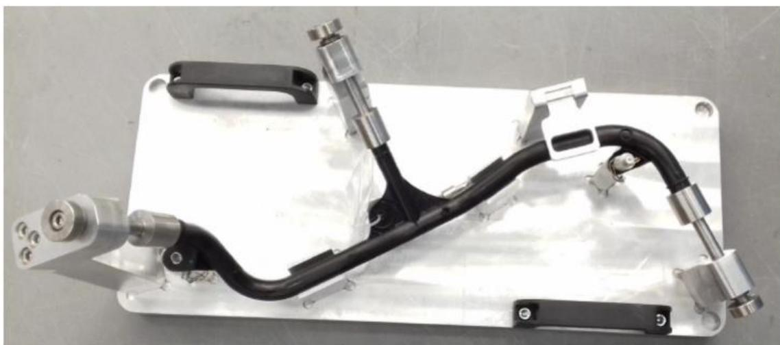
A continuación se muestra la referencia **O5E 122 447 J** ya con el tubo plástico (V00075), inserto metálico (H77391), mangueras (H66821) (H69701), abrazaderas (H02290) (H16168) (H10864) ya como producto terminado:
