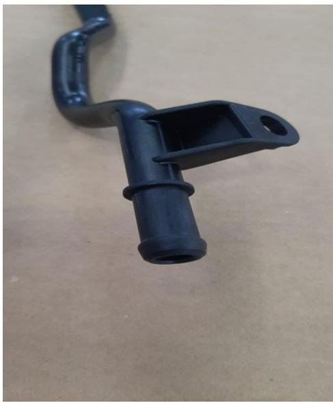
Así es como queda el acabado después de realizar el proceso de fresado o desbaste en el tubo semiterminado.
