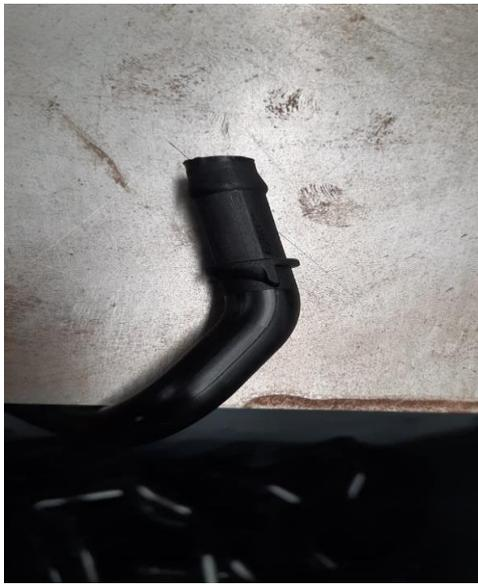
Así es la apariencia de los extremos del tubo semiterminado antes del proceso de fresado.
