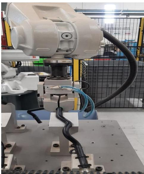
El brazo robótico toma el tubo semiterminado del fixture para realizar el proceso de fresado de los extremos.
